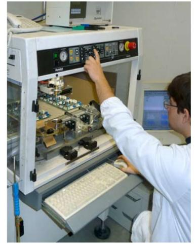
**Laboratorio per il conformal coating. Attraverso resinature e verniciature Pimas garantisce il perfetto funzionamento a lungo termine delle schede elettroniche anche in condizioni critiche di temperatura, umidità, polvere e aggressivi chimici.**
